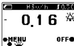
Innerhalb von 40 s nach Einschalten zeigt das Gerät die erste Anzeige an, die als eine Seite eines Rechtecks „■“ präsentiert wird und die Zahl der durchgeführten Beobachtungen anzeigt.
