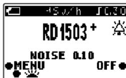
Die Differenz einer Dosisrate zwischen dem Wert (im Beispiel  $0,05 \mu\text{Sv/h}$ ) und dem Hintergrund (im Beispiel  $0,10 \mu\text{Sv/h}$ ) wird nach dem Ende des Zyklus angezeigt. Damit ist der Betrag eines Durchschnittswertes  $0,15 \mu\text{Sv/h}$ .
