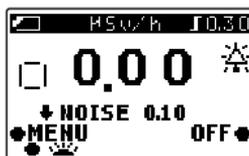
Der Wechsel vom „BACKGROUND (HINTERGRUND)“- in den „MESSUNG“-Modus erfolgt im „BACKGROUND (HINTERGRUND)“-Abschnitt im Menü (Seite 20), indem das „✓“-Icon neben die Anzeige „OFF (AUS)“ gesetzt wird.
